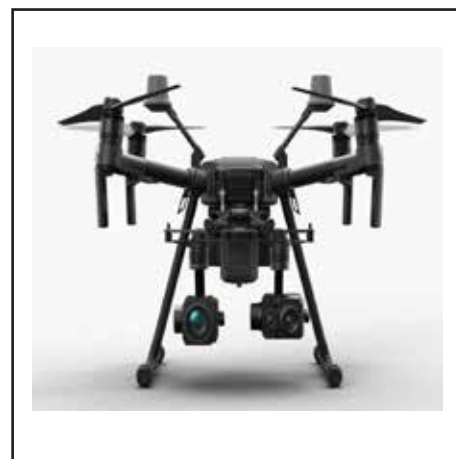
Drone Kéo dây và kiểm tra Drone for Power Transmission Line
